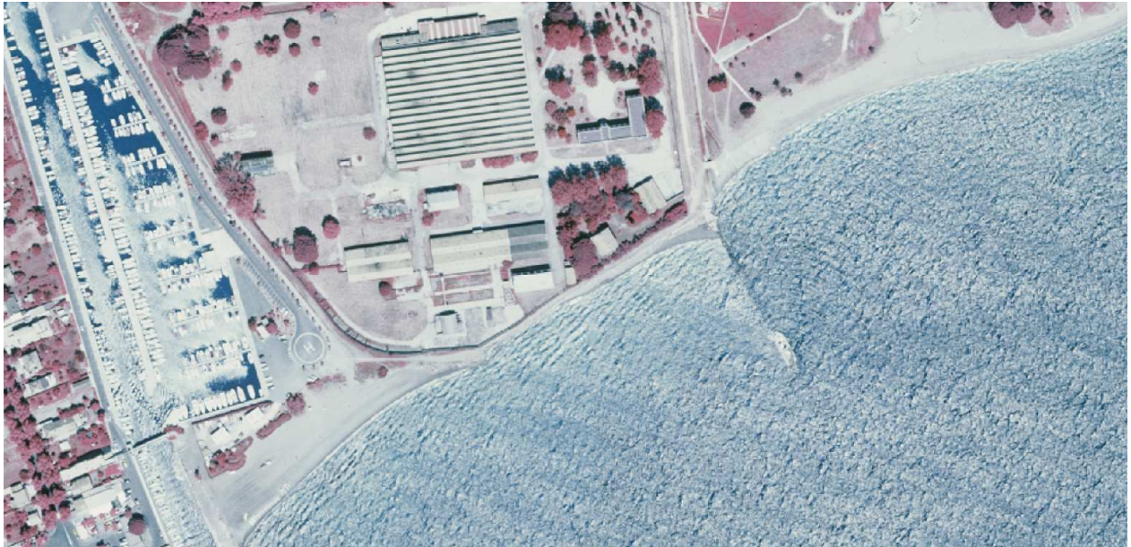
Figure 4-2 Image aérienne Infra Rouge du 19/06/1995 montrant une accumulation côté Ouest de l'ancienne digue DCNS.
