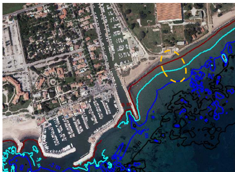
Figure 5-1 : Zone d'influence (contour orange) attendue des ouvrages sur les fonds sableux.
